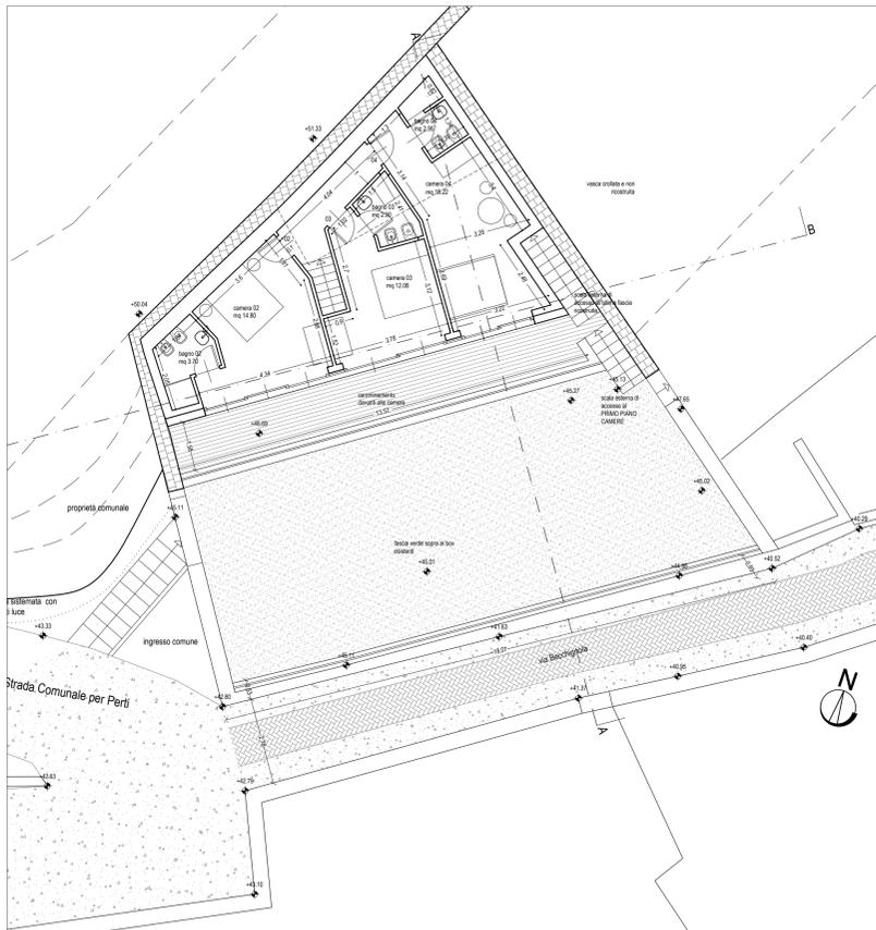
PROGETTO: Pianta piano primo fascia ricostruita sopra all'esistente, scala 1/100
