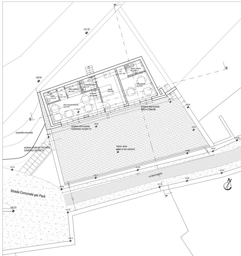
PROGETTO: Pianta piano terra sopra ai box, scala 1/100
